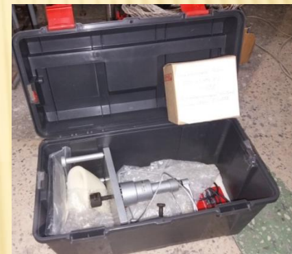
Измеритель адгезии методом нормального отрыва
