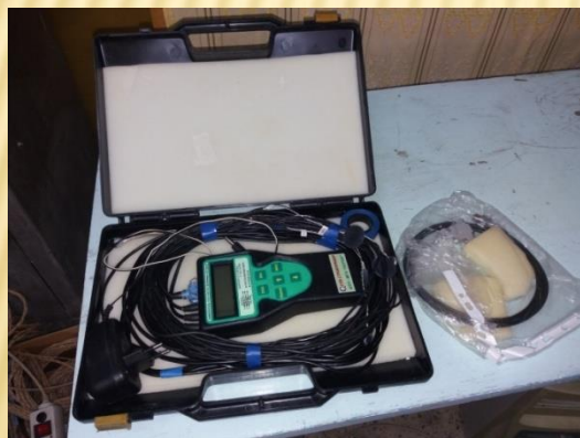
Измеритель плотности тепловых потоков и температуры
