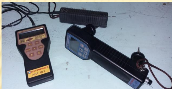
Измеритель толщины защитного слоя бетона и расположения арматуры и ультразвуковой прибор
