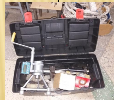
Измеритель прочности бетона методами отрыва со скалыванием ребра
